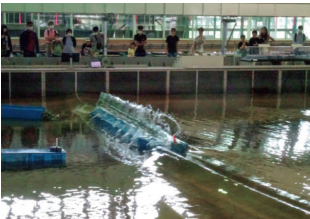
寒冷沿岸域チームの展示状況 (大型平面水槽で起こした津波が防波堤に作用する様子)
