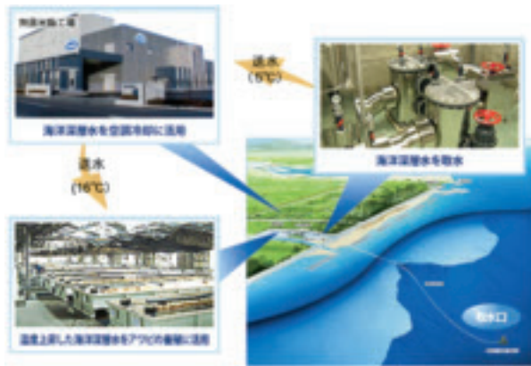
図 11. 富山県入善町で無菌米飯工場の冷房とアワビ養殖場を連携させて海洋深層水の冷熱の多段利用を行った国内初の例
