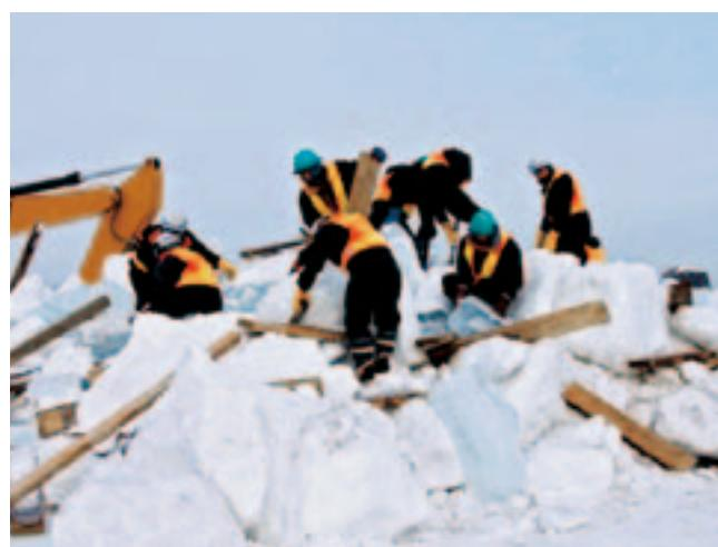
冬期の津波を想定した堆積流氷の撤去実験の様子
