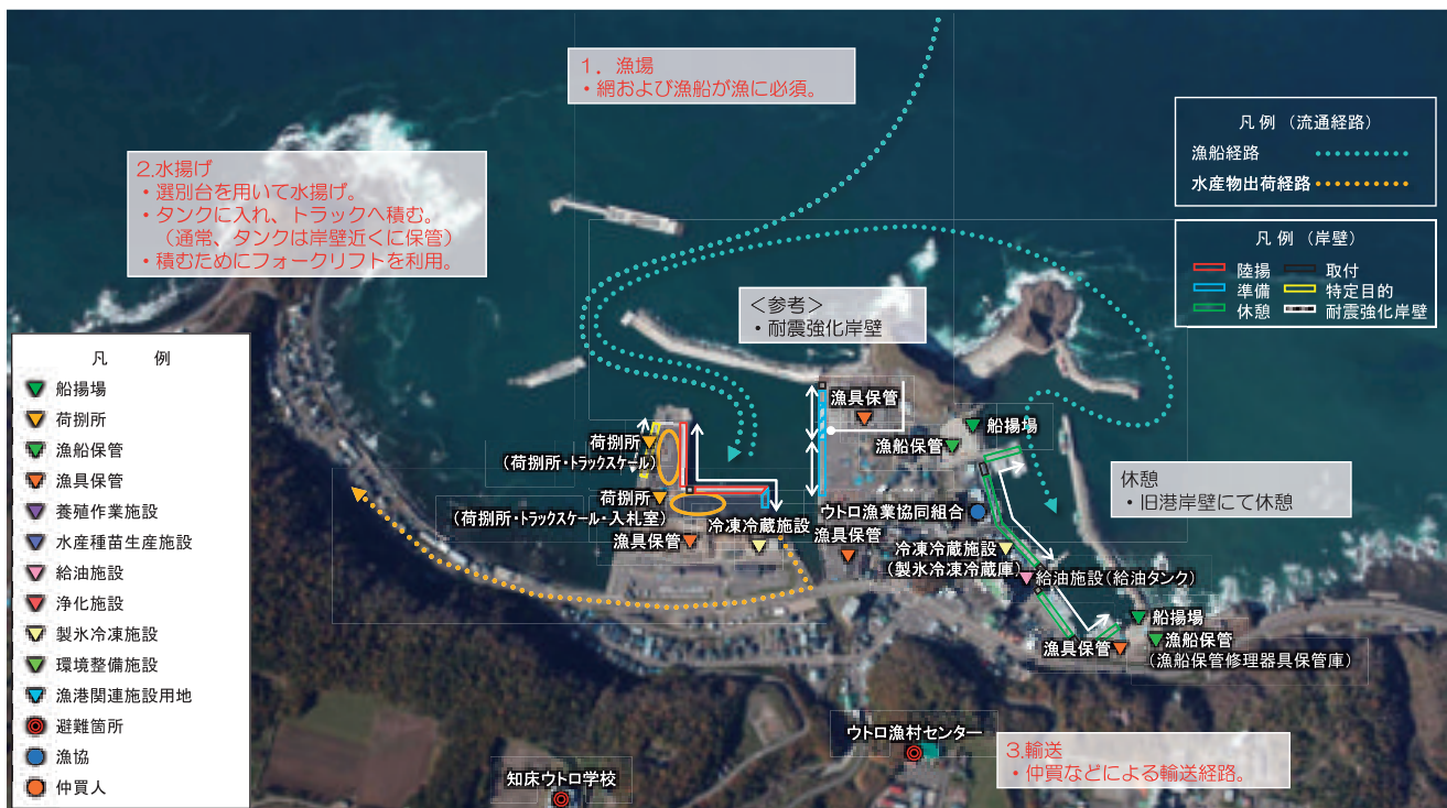
図-2 ウトロ漁港 水産物流通特性の整理 (サケ定置網漁業)
