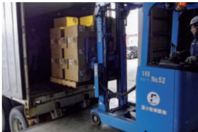
小口混載貨物のバンニング作業（苫小牧）
