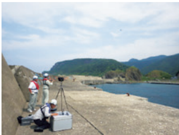
UAV（ドローン）を用いた空中写真測量
